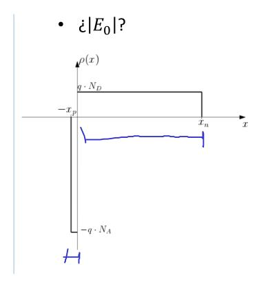
Guia 2. Ej 7: Se tiene una juntura  $P^+N$  donde se sabe que sin potencial aplicado el máximo valor alcanzado por el campo eléctrico es  $|E_0| = 10 \, \mathrm{kV/cm}$  y que  $N_D = 4.5 \times 10^{14} \, \mathrm{cm}^{-3}$ .
